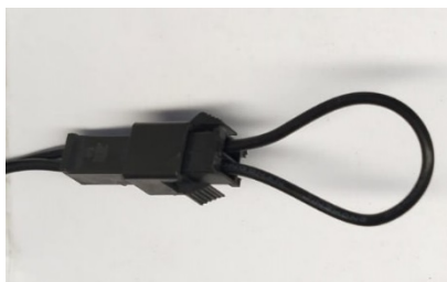
Рис.11 Штекер с перемычкой комнатного термостата
